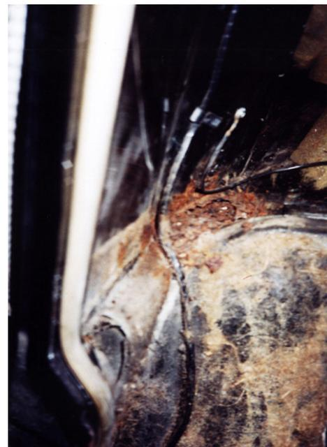
Weitere Problemzonen sind die Türen. Verstopfte Ablauflöcher sind der Tod der Portale. Die Bohrungen für die Halterungen der Pallaszierleisten ziehen den Rost förmlich an. Die angebotenen Reparaturbleche ermöglichen dem versierten Schweißer ein problemloses Wiederaufbauen der Türen.
